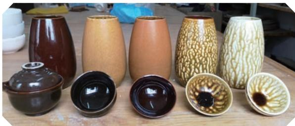
河北金厂峪尾矿制作的结晶纹理釉在陶瓷产品上的效果
