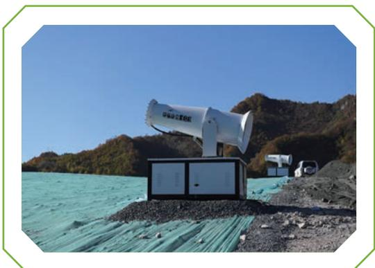
河北峪耳崖公司堆浸厂安装环保除尘雾炮机
